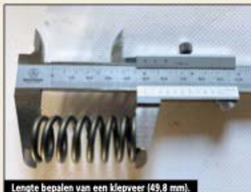
Lengte bepalen van een klepveer (49,8 mm).
