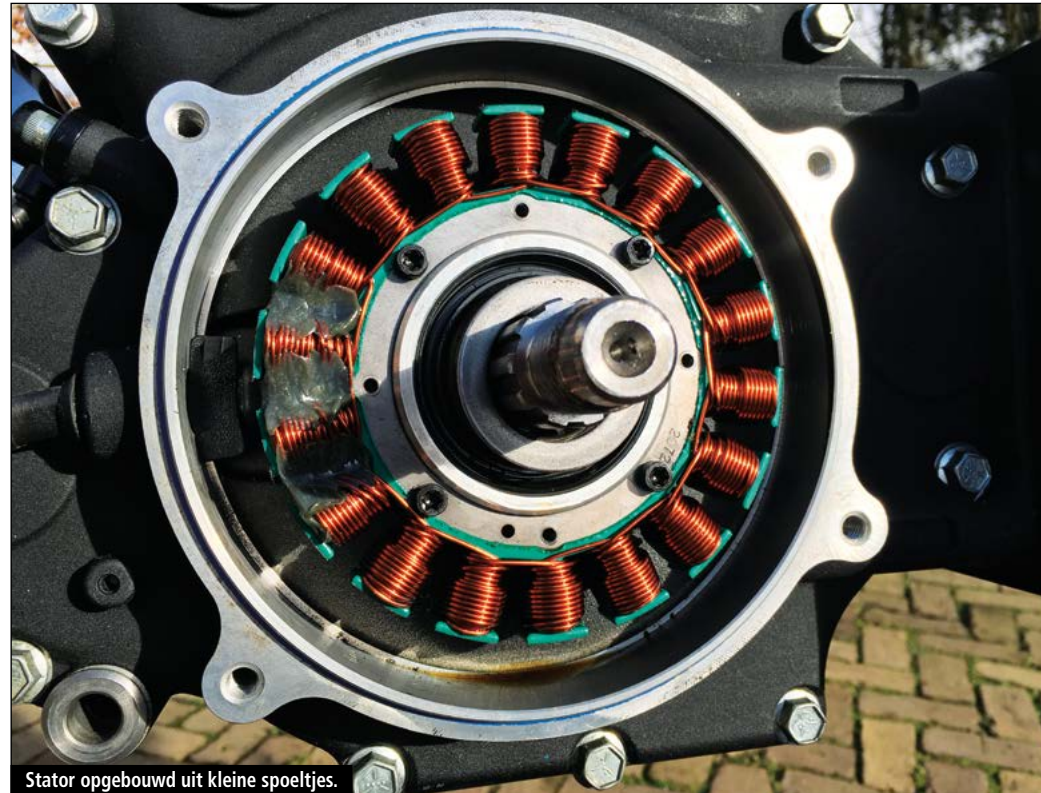
Stator opgebouwd uit kleine spoeltjes.
