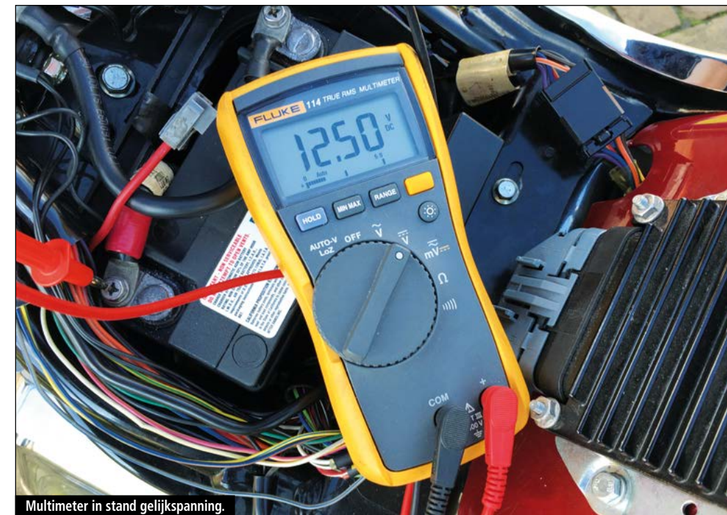
Multimeter in stand gelijkspanning.
