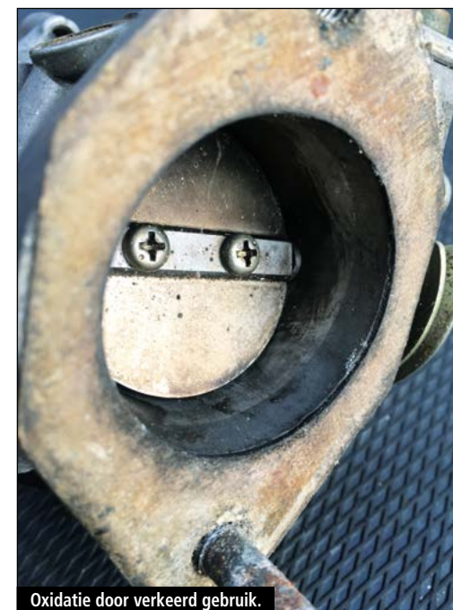
Oxidatie door verkeerd gebruik.
