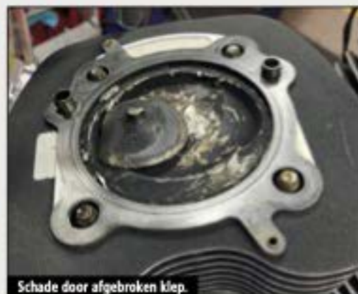
Schade door afgebroken klep.
