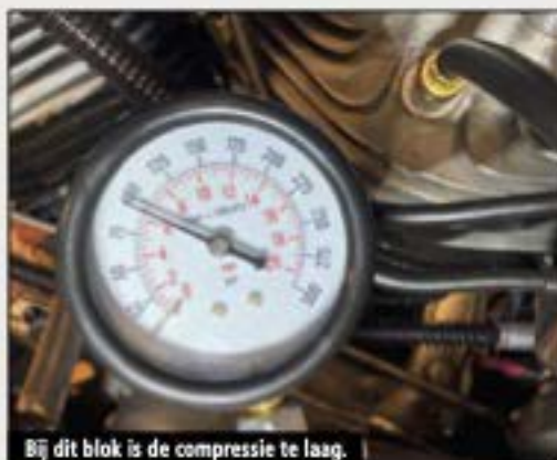
Bij dit blok is de compressie te laag.
