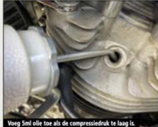
Voeg 5ml olie toe als de compressiedruk te laag is.
